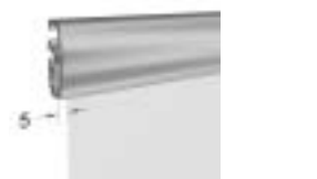
When using mag-edge, increase panel width with 10mm to line up with top and bottom bar Vid användning av mag-edge öka panelens bredd med 10mm för att linjera med topp- och bottenprofil
